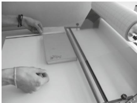
Poté filcovou stěrkou fólii přihladíme na povrch knižní desky, hladíme postupně směrem od sebe až k okraji vodiče fólie (obr.6).
