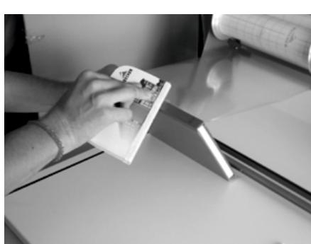
Nakonec polaminovanou knihu odřízneme od folie z laminátoru, počítejte s přesahem pro založení fólie do vnitř desek knihy, pro odříznutí lze proto využít některou z odřezávacích lišt (obr.9).
